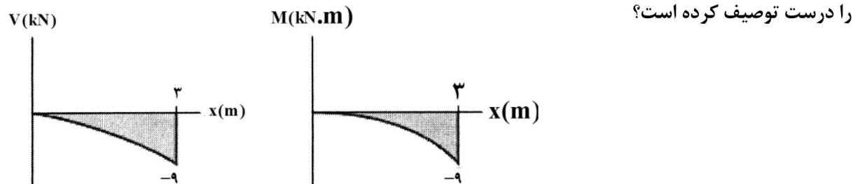
(۱) تیر ساده که در ابتدای آن، تکیه‌گاه مفصلی با شدت بار  $\frac{kN}{m} 6$  و در انتهای آن، تکیه‌گاه غلتکی با شدت بار صفر است.
