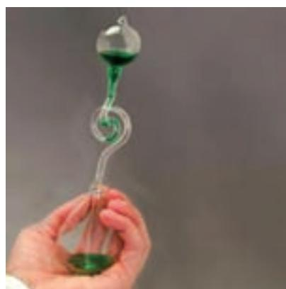
شکل ۲۳-۶— با در دست گرفتن حباب شیشه‌ای و گرم کردن آن، مایع رنگی در لوله ماربیچ بالا می‌رود.
