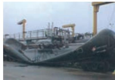
شکل ۲۲-۶— سرد شدن هوا درون مخزن باعث کاهش فشار این هوا و در نتیجه مچاله شدن مخزن شده است.
