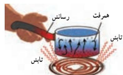
شکل ۶-۹ - در این شکل، هر سه روش انتقال گرمایی در تصویری مشاهده می کنید.
