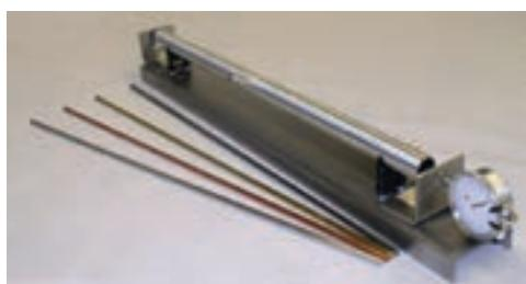
**وسایل آزمایش :** دستگاه اندازه‌گیری ضرب انساط طولی با چند لوله فلزی توخالی از جنس‌های مختلف، ارلن با دربوش سوراخ دار، لوله لاستیکی، توری، سه‌پایه و چراغ گاز
