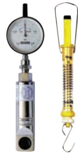
شکل ۱-۳- نمونه‌هایی از چند نیروسنج
