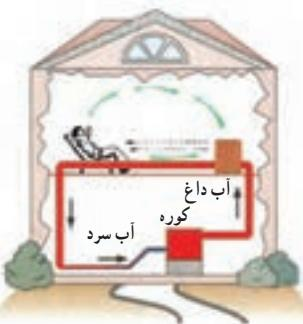
شکل ۱۴-۶—گرم شدن هوای اتاق به روش هم‌رفت
