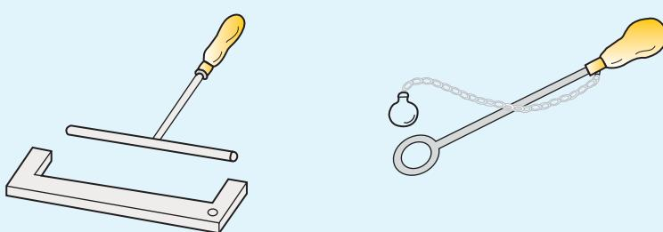
بیشتر اجسام با افزایش دما انبساط پیدا می‌کنند و یا با کاهش دما حجمشان کم می‌شود. این پدیده اساس ساخت بعضی از دماسنجهای و دمایا (ترموستات) است – بی توجهی به پدیده انبساط در ساختن پل‌ها، خط آهن‌ها، خطوط انتقال نیرو، خطوط انتقال سوخت و ... می‌تواند مشکل‌هایی را ایجاد کند.
