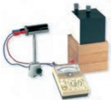
شکل ۱۹-۷- درون مکعب‌سیلی آب داغ می‌ریزند. تابش گرمایی از چهار وجه جانبی مکعب، که رنگ‌های متفاوتی دارند، با هم فرق دارد.
