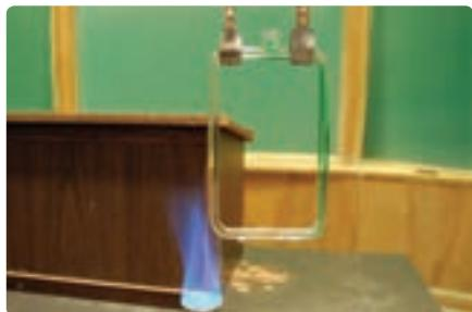
**وسیله‌های آزمایش:** لوله هرفت، گیره و پایه، آب سرد، دانه‌های پرمنگات پتاسیم یا جوهر، شعله گاز
