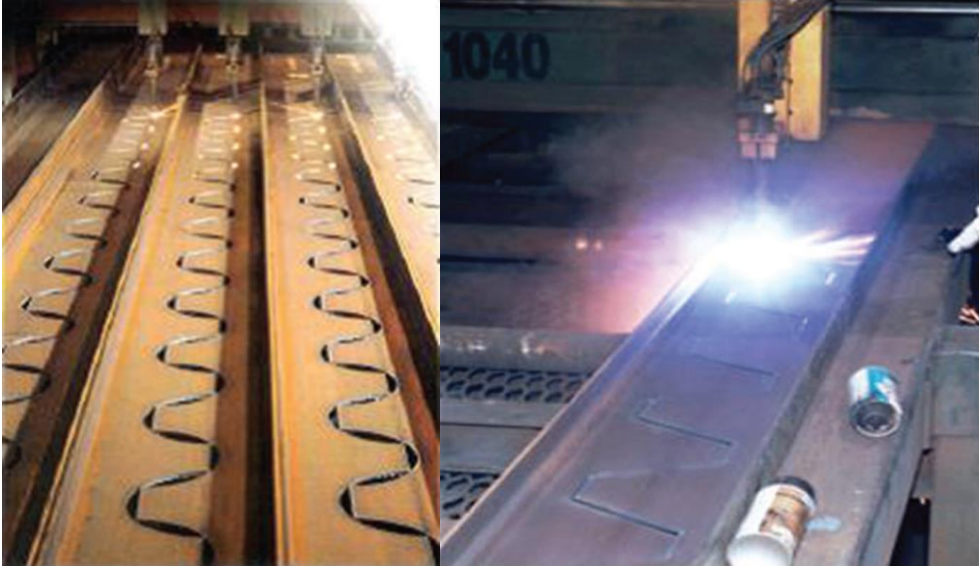
شکل ۳-۱: نحوه برش الگوی لانه زنبوری با دستگاه
