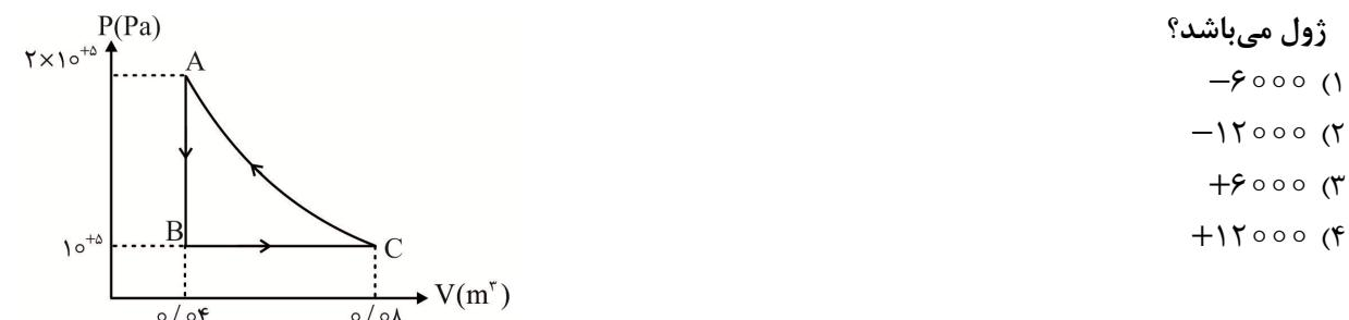
۱۴۲- نمودار  $(P - V)$  یک گاز کامل تک اتمی مطابق شکل است. گاز در طی فرایند ABC ژول گرما
