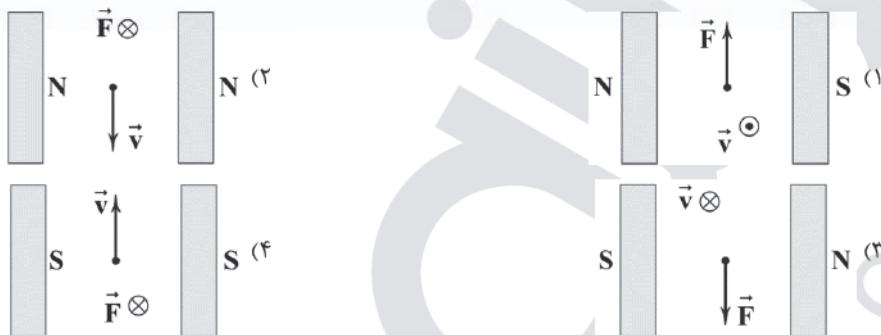
۱۴۳- مطابق شکل زیر، سیم راست حامل جریانی به طول  $10\text{ cm}$  داخل یک میدان مغناطیسی یکنواخت قرار گرفته است. اگر به این سیم نیرویی به اندازه  $N/6$  وارد شود، به ذرهی  $q = -2\mu\text{C}$  که با تندی  $\frac{m}{s} 10^5$  وارد این میدان مغناطیسی می‌شود، نیرویی به بزرگی چند نیوتون به این ذره وارد خواهد شد؟
