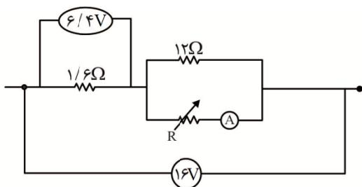
است. جریان الکتریکی عبوری از مقاومت  $12\Omega$  برابر  $I_1 = \frac{9 / 6}{12} = 0.75A$  است. در نتیجه از مقاومت  $R$ ، جریان
