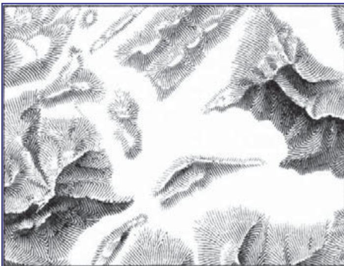
شکل ۱۲— نورپردازی و استفاده از هاشور برای نمایش دادن ارتفاعات در نقشه
