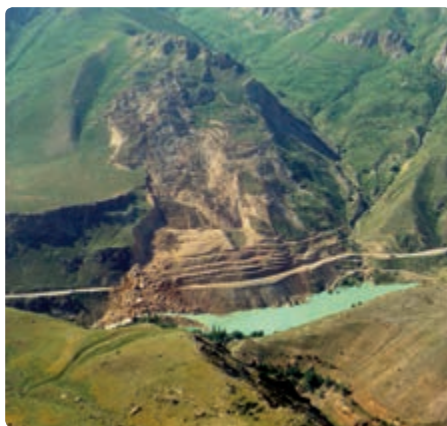
شکل ۶-۲۱- تشکیل دریاچه به وسیله سد طبیعی از لغزش دامنه‌ها - منطقه آب اسک جاده هراز
