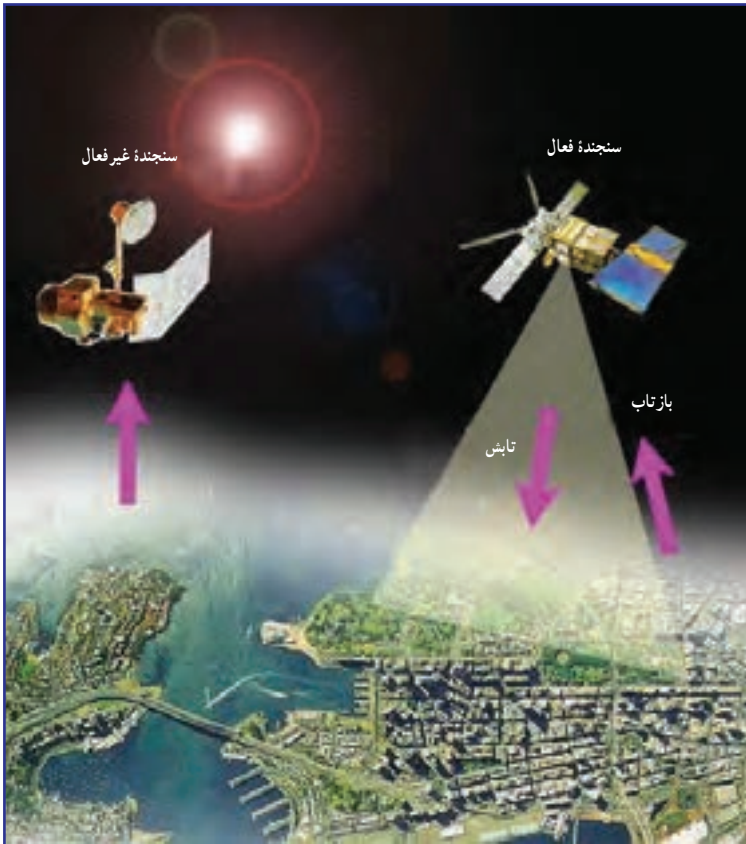
شکل ۳- نمایی از سنجندهٔ فعال و غیرفعال در ماهواره‌های سنجش از دور
