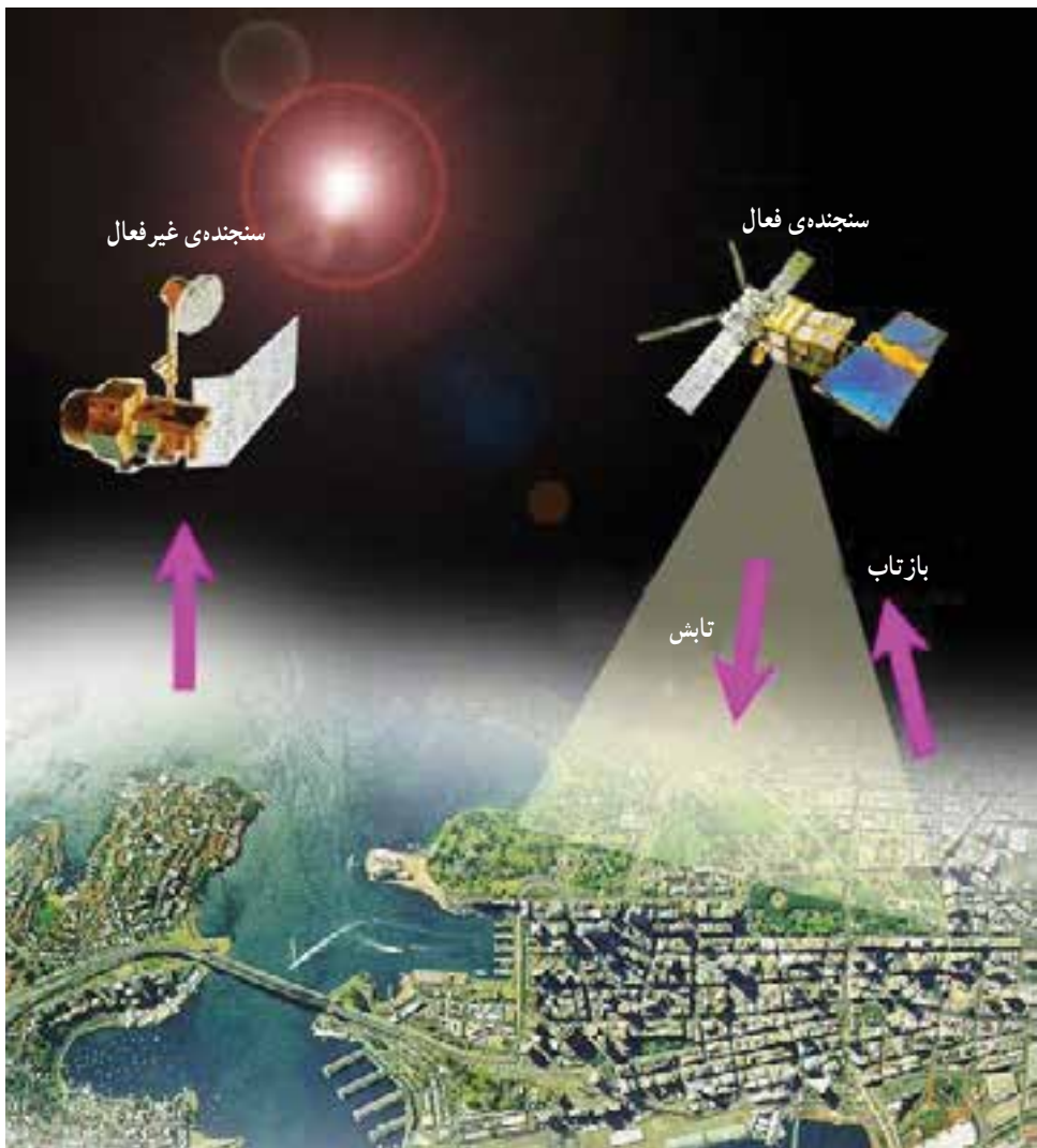
شکل ۳- نمایی از سنجنده‌ی فعال و غیر فعال در ماهواره‌های سنجش از دور
