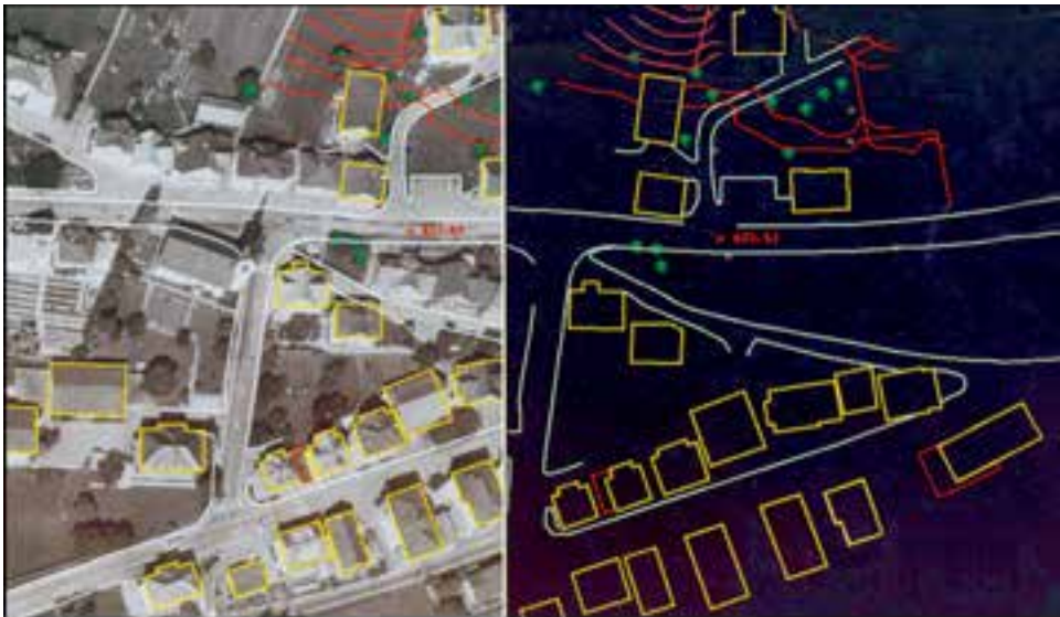
شکل ۸- تهیه نقشه از روی عکس هوایی
