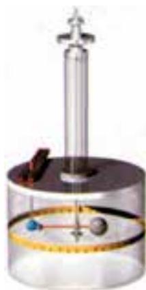
شکل ۱-۱۵- ترازوی پیچشی کولن
