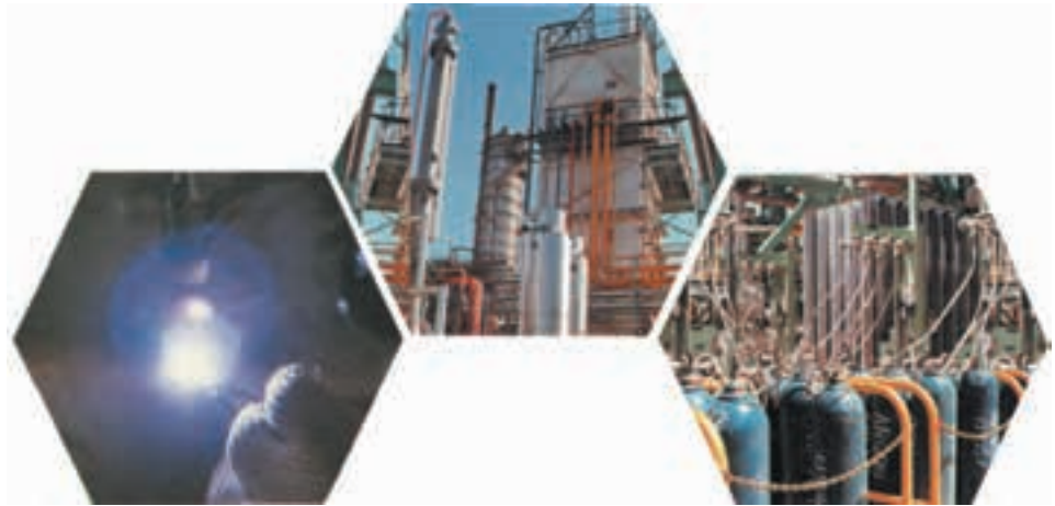
شکل ۱۷ واحد تولید گاز آرگون در مجتمع پتروشیمی شیراز. این واحد که در سال ۱۳۷۳ به بهره‌برداری رسیده است، سالانه ۵۰۰۰ تن گاز آرگون تولید می‌کند. گاز آرگون برای جوشکاری، برشکاری و پرکردن لامپ‌های مهتابی به کار می‌رود.
