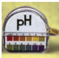
نواری کاغذی آغشته به مخلوطی از چند شناساگر که به عنوان شناساگر عمومی شناخته می‌شود. از روی تغییر رنگ این نوار کاغذی pH یک محلول معین می‌شود.
