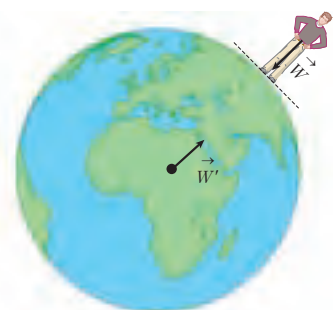
شکل ۲-۶ زمین بر جسم نیروی گرانشی ( \vec{W} ) وارد می‌کند و جسم نیز بر زمین نیروی گرانشی ( \vec{W}' ) وارد می‌کند.
