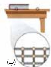
شکل ۷-۳: نیروی بین مولکول‌های سطح میز با فنرهایی شبیه‌سازی شده است. با قرار گرفتن کتاب، فنرها فشرده شده‌اند.
