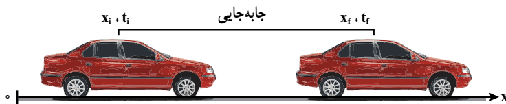
شکل ۵-۲ جابه‌جایی در بازه زمانی t_i تا t_f
