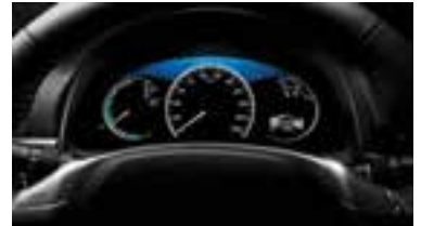
شکل ۲-۹- سرعت‌سنج خودرو در هر لحظه، اندازه سرعت لحظه‌ای را نشان می‌دهد.
