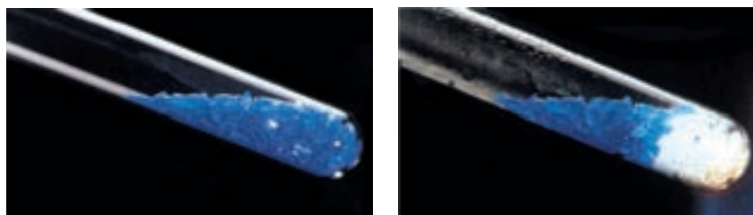
الف) تبدیل مس (II) سولفات پنج آبه به مس (II) سولفات خشک
