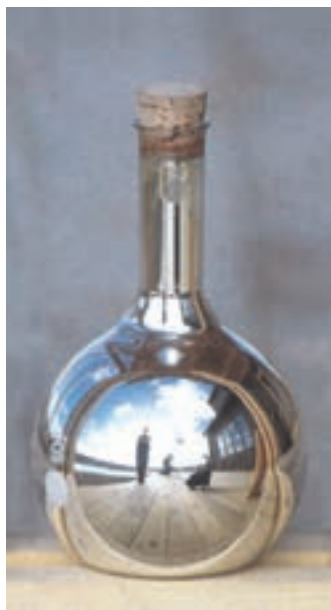
تشکیل آینه نقره‌ای هنگام اکسایش متانال
