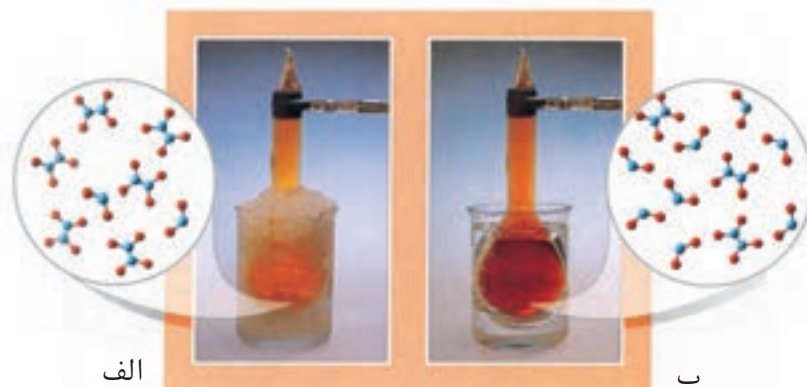
شکل ۷- تعادل میان گازهای \text{NO}_2 و \text{N}_2\text{O}_4 در دو دمای مختلف
