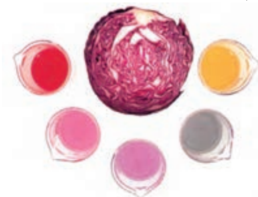
شکل ۹- آب کلم سرخ به عنوان یک شناساگر اسید-باز عمل می کند. محلول های نشان داده شده از چپ به راست pH های ۱، ۴، ۷، ۱۰ و ۱۳ دارند.
