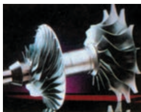
از سرامیک‌ها برای تولید تیغه‌ی توربین‌ها،
