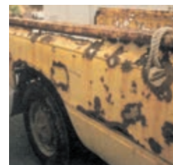
شکل ۴ واکنش پذیری آهن موجب از بین رفتن بدنه ی این وانت شده است.
