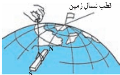
شکل ۳-۳-قطب‌نمایه‌ایی که ملاحان در دریا و کوهنوردان به هنگام مه غلیظ برای تعیین جهت حرکت به کار می‌برند، در واقع یک آهنربای میله‌ای نازک است که بر روی پایه‌ای سوار است و می‌تواند آزادانه بر روی آن بچرخد، و جهت تقریبی شمال را نشان دهد. قطب‌نما را عقریه‌ی مغناطیسی هم می‌نامند.
