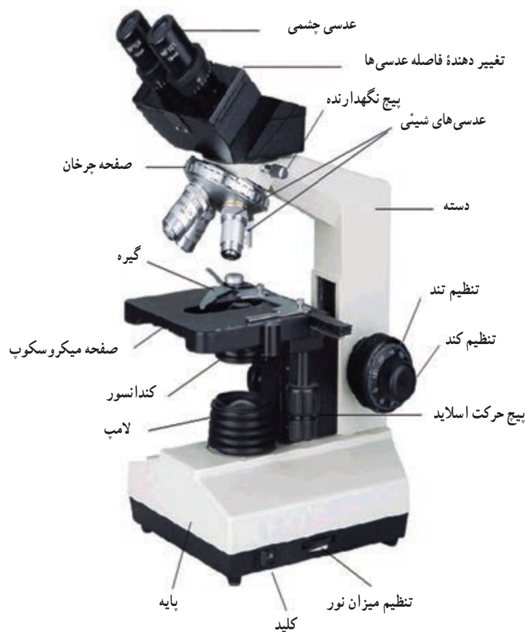
شکل ۲-۴- بخش‌های اصلی یک میکروسکوپ نوری
