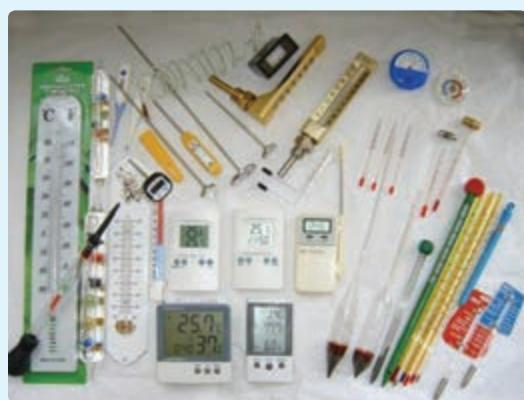
امروزه از انواع دماسنج‌ها در زندگی روزمره استفاده می‌شود. برخی از این دماسنج‌ها عبارت‌اند از: دماسنج ترموموکوپل، تئسنج، دماسنج نواری (کربستال مایع)، دماسنج الکترونیکی و ... . تحقیق کنید که هریک از این دماسنج‌ها چه گستره دمایی را می‌تواند اندازه‌گیری کند.
