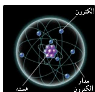
شكل ۲-۲ در اتم خنثی تعداد پروتون‌های موجود در هسته هر اتم برابر تعداد الکترون‌های آن اتم است. هسته با تعداد الکترون‌ها برابر است.
