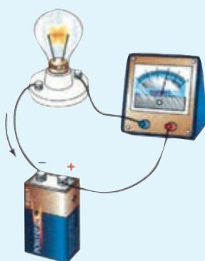
در دوره راهنمایی دیدیم وقتی در یک مدار ساده مانند مدار نشان داده شده در شکل، آمپرسنج را در نقاط مختلف مدار قرار می‌دهیم، جریان یکسانی را نشان می‌دهد. علت آن را با توجه به پایستگی بار الکتریکی، انباسته نشدن بار در سیم‌ها و اجزای مدار، و تعریف جریان الکتریکی توضیح دهید.
