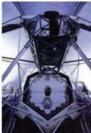
شکل ۵-۴۰—تلسکوپ کِک در هاوایی. در این تلسکوپ از بازتاب نور توسط تعدادی آینه مکفر استفاده می‌شود.
