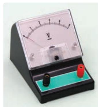
شکل ۱۴-۳ – با ولت سنج اختلاف پتانسیل دو سر مولد، یادو نقطه از مدار را اندازه می گیریم.
