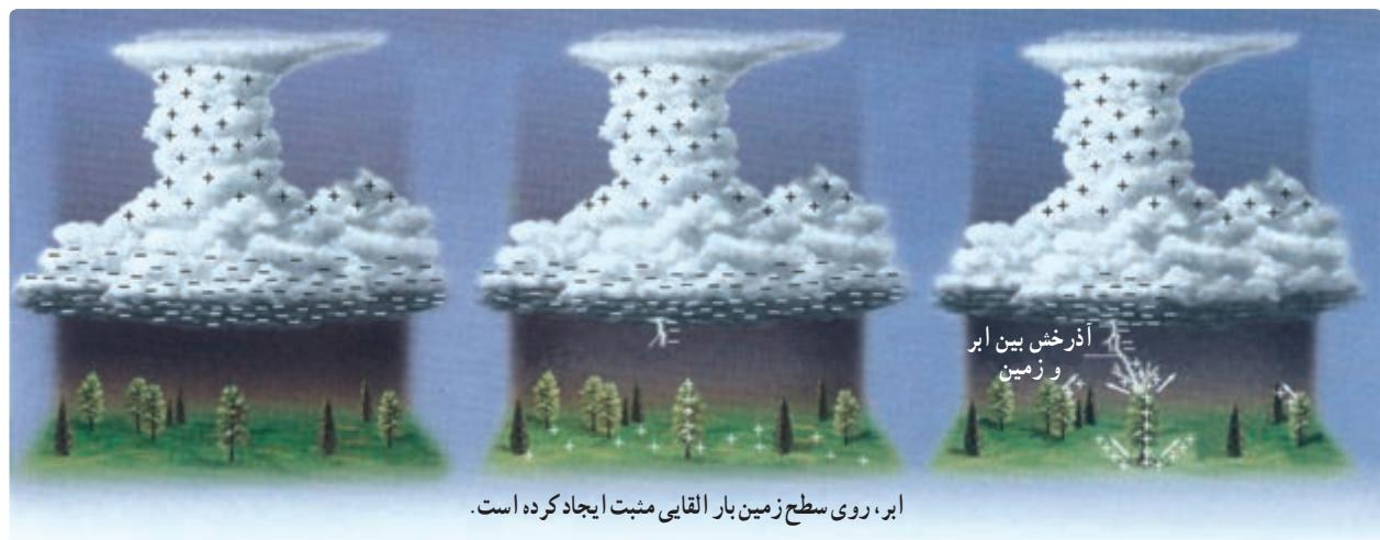
شکل ۳-۶—وقتی ابری که بار الکتریکی دارد نزدیک سطح زمین قرار بگیرد در سطح زمین بار القایی ایجاد کرده است.
