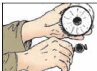
۳- ضمن بستن دریچه‌ی خروجی هوا (با کف دست) با فشار هوای موجود در سینه، هوای آلوده‌ی درون ماسک را خارج کنید.
