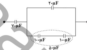
دو خازن  $100 \mu F$  با هم متوالی و معادل آن‌ها با خازن  $20 \mu F$  موازی است و در نهایت معادل آن‌ها نیز با خازن  $70 \mu F$  متوالی است.
