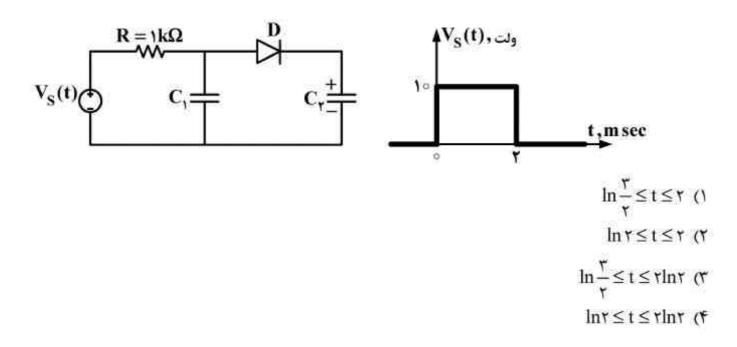
۴۶ مدار شکل زیر، به ازای چه مقدار مقاومت R (بر حسب اهم) نوسان میکند؟
